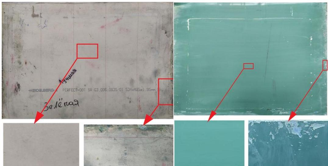
Рисунок 1. Вид поврежденных (справа) и неповрежденных (слева) участков РТК
